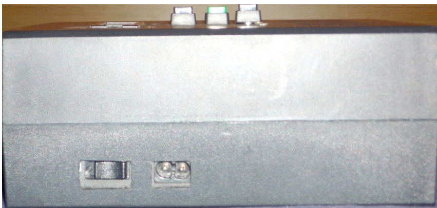
Obr. 41 konektor pro připojení antény a střídavého napětí ze sítě
