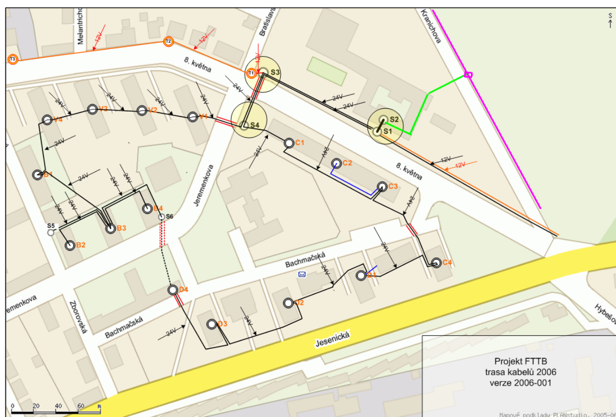
Obr.2: Schéma sítě FTTB realizované ve městě Šumperk v první etapě.
