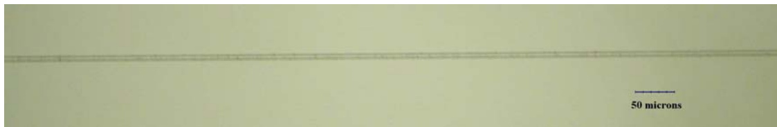
Obr. 10: Mikroskopická fotografie podélné struktury pasu zúženého jednobodového vlákna s průměrem 8 \mu\text{m} .
