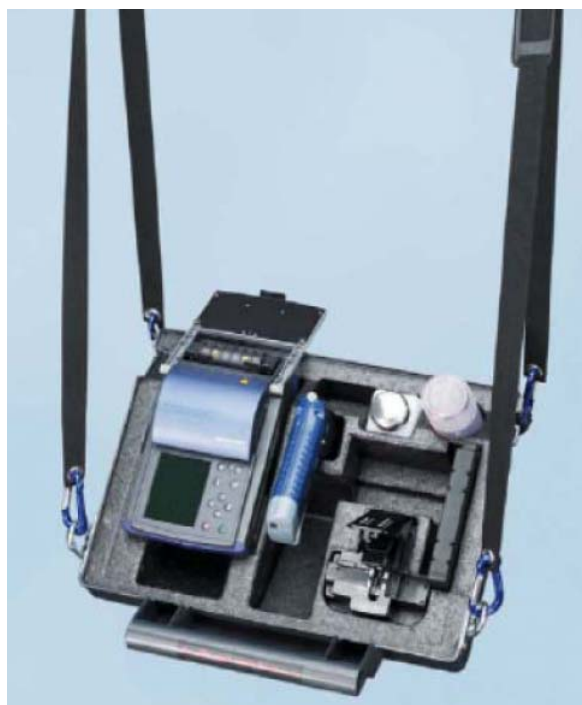
Obr. 11: Kufřík jako pracovní stanice se závěsnými popruhy.
