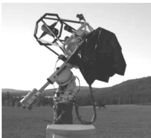
Obr. 15: Přenosná zemská stanice použitá při experimentu CAPANINA v Kiruně (podle [14]).
