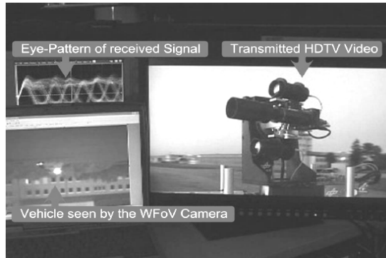
Obr. 18: Optická část spoje umístěná na pohybujiícím se vozidle spolu s diagramem oka a vysílaným svazkem snímaným CCD kamerou (podle [12], projekt MOND).
